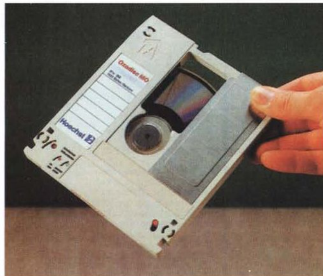
I primi dischi magnetici ottici, dimensioni 5"1/2, capacità 650MB, riscrivibili su ambedue i lati. Un bel salto nella scalata dei Megabyte, ma il driver costa la bellezza di una diecina di milioni!!.
